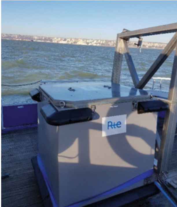
Figure 8 Caisson RTE de recherche de défaut embarqué sur un navire
